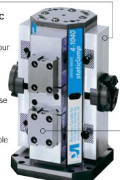
Le changement des mors et des plaques de serrage se fait ici simplement et rapidement. La construction pratique de la plaque de base en permet l'utilisation sur tous les systèmes de machines usuels. Avec les dispositifs de montage pivotants et les plateaux tournants, la tour *staticlamp* peut également être utilisée sur les centres d'usinage verticaux.
